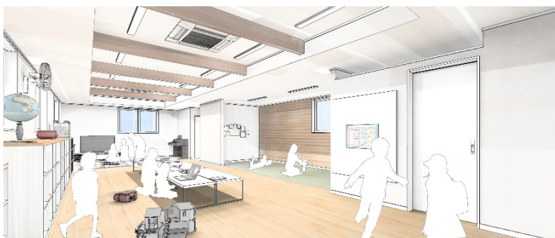
梁を現しとし、天然木のフローリングや豊田市産木材の羽目板を使用した室内空間（画像はイメージ）
